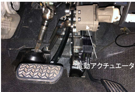
電動アクチュエータの取付け (ブレーキペダルにブラケットを介して取付け)
