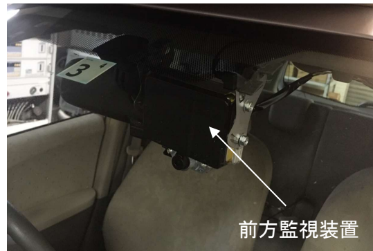
前方監視装置の取付け(バックミラー死角)
