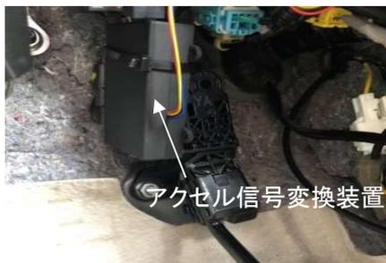
アクセル信号変換装置
